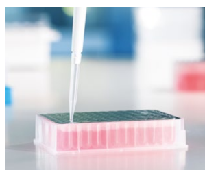
50 – 1000 µl Pipettenspitze in eine Deep-well Platte
